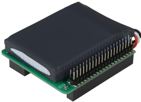
Dieser BatteryHat macht aus dem Strompi V3 eine vollwertige USV-Lösung. Der Akku steht als dritte Stromquelle zur Verfügung, wird überwacht und automatisch nachgeladen.
